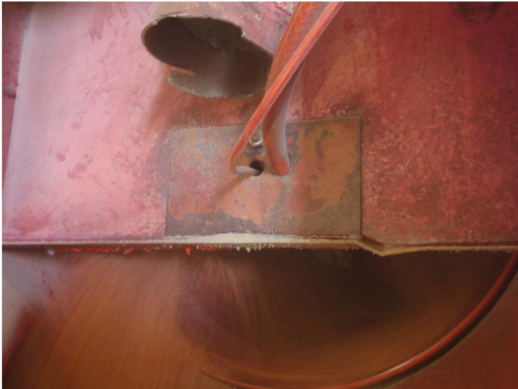
Foto 7. Dosificación del producto con manguera ayudada por aire comprimido sobre el grano girando en el tambor
